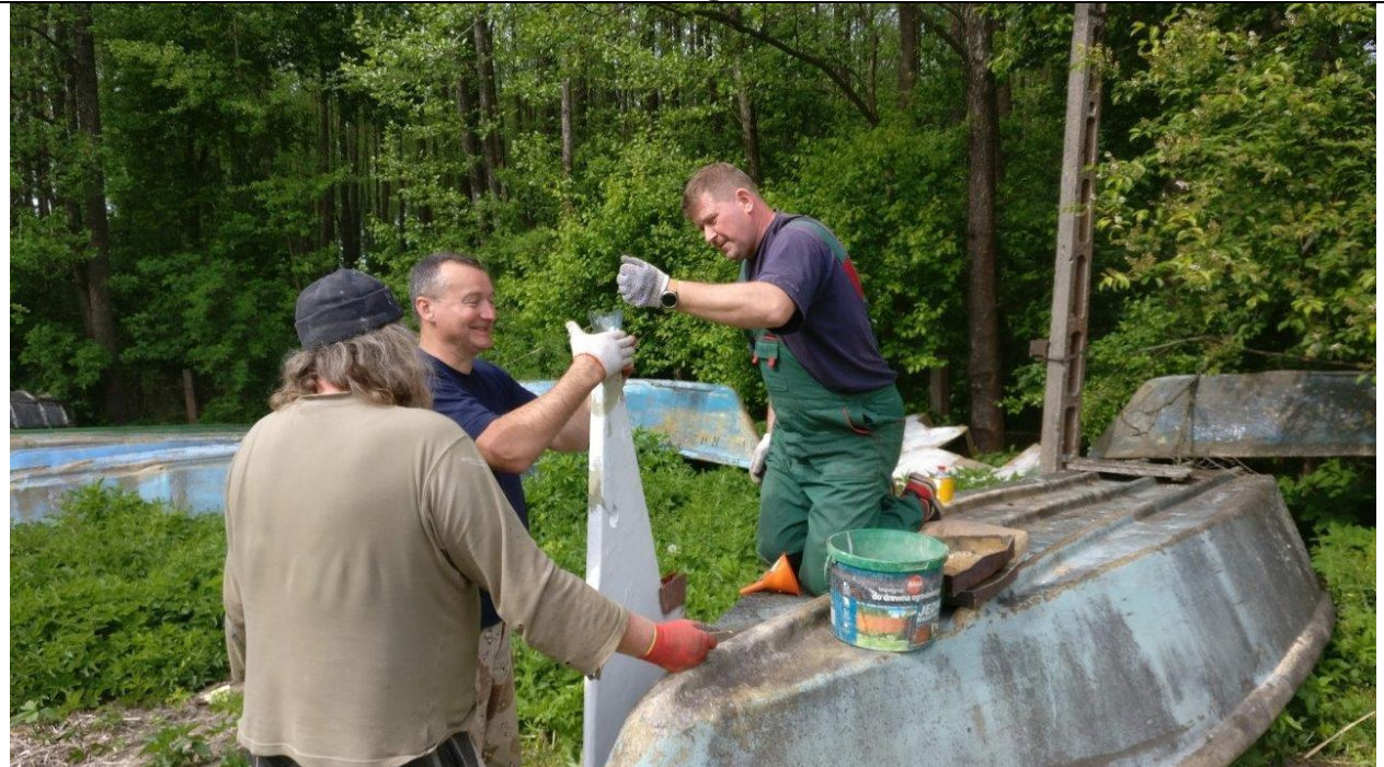
Napełnianie profilowanego, stalowego miecza śrutem ołowianym i żywicą poliestrową.
